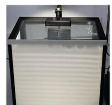
Appareil à assembler pour l'étude de la propagation des ondes dans l'eau. Produit rapide à installer : montage en moins de 5 mn. Stroboscope à LED sur flexible aimanté avec fréquence synchrone / asynchrone. Lecture directe de la fréquence du générateur d'ondes. Réglage de niveau par 4 pieds réglables et niveau à bulle
