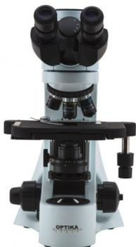
Tête : Binoculaire Objectifs : E-Plan Achromatiques - IOS (Correction à l'Infini) 4x/0.10, 10x/0.25, 40x/0.65 et 100x/1.25 (Huile) Platine : 216 x 150 mm avec surplatine 78 x 54 mm à déplacement par courroie d'entraînement Dispositif CAL - Contrôle Automatique de Lumière
