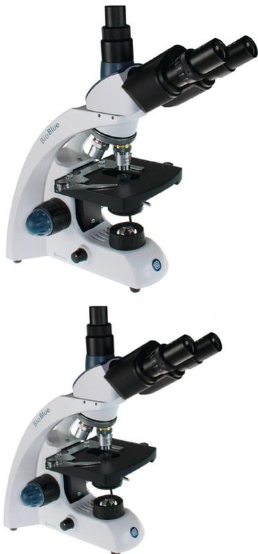
Ojectifs SMP 600 x et Platine à déplacement X-Y Tête : Trinoculaire inclinée à 45°, tournante sur 360° Objectifs : SEMI-Plans Achromatiques DIN 4x/ 0.10, 10x/0.25, S40x/0.65, S60x/0.85 Objectifs 40x et 60x Rétractables Eclairage : à Diode électroluminescente LED de 1 Watt avec intensité réglable, batterie intégrée rechargeable et alimentation externe sur transformateur inclus.
