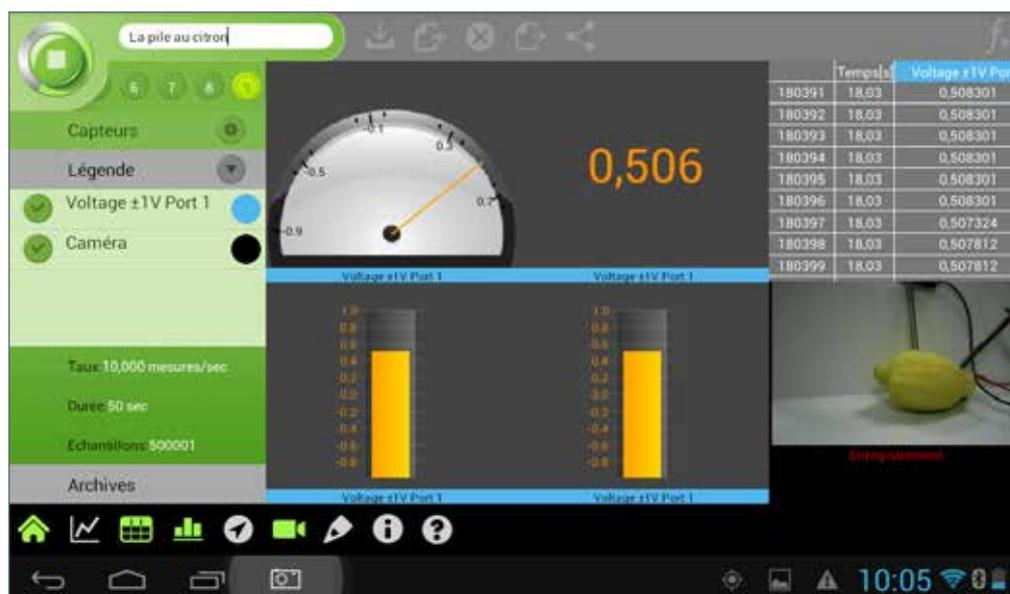
On mesure une tension de 0,506V aux bornes des électrodes.
