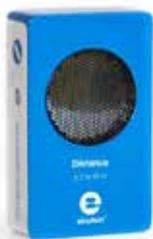
Ce capteur numérique à ultrasons permet de mesurer la distance entre le capteur et un objet placé entre 0,2 et 10 mètres. Plus encore, il est capable d'étudier les concepts physiques de position, de vitesse, d'accélération ou encore le déplacement d'une balle lancée en l'air.
