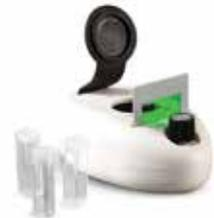
Le dispositif mesure l'intensité de la lumière transmise à travers un échantillon à une longueur d'onde sélectionnée.
