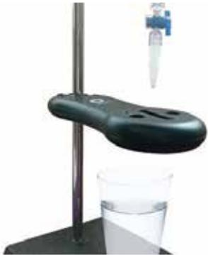
Ce dispositif compte-gouttes est muni d'un capteur optique conçu pour mesurer le nombre de gouttes de titrant versé pendant un dosage. Il est capable de convertir automatiquement le nombre de gouttes versées en volume. Combiné à la fois au capteur pH et au capteur température, il vous permet de déterminer le point d'équivalence lors d'un dosage acido-basique. Il peut être également utilisé pour des études de conductimétrie ou potentiométriques avec les sondes de conductivité ou ions-spécifiques.
