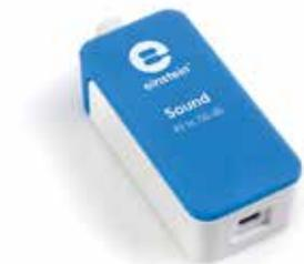
Ce capteur permet de mesurer des niveaux sonores en décibels allant de 45 à 110dB. Il est idéal pour la mesure du niveau de bruit environnemental ou l'étude de l'isolation acoustique d'une pièce. Un filtre spécial élimine tout bruit parasite. Il possède 3 étages d'amplification qui permettent de façon automatique entre eux, garantissant une gamme de mesure et une flexibilité maximum.
