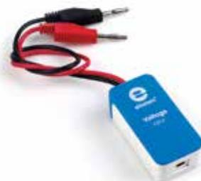
Le capteur différentiel est un voltmètre capable de mesurer des valeurs allant de -25 V à +25 V. Mesurant à la fois des tensions alternatives et continues, il est doté de 2 fiches bananes 4mm à reprise arrière. Ce capteur dispose également d'une entrée flottante, vous pouvez donc le connecter à un circuit sans aucun risque.
