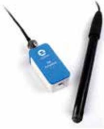
Ensemble composé d'une électrode sensible aux Ions Chlorure et d'un boîtier adaptateur. Electrode ionique pré-remplie à gel Permafil avec chambre de référence scellée (non remplissable). Aucune solution de remplissage n'est nécessaire.
