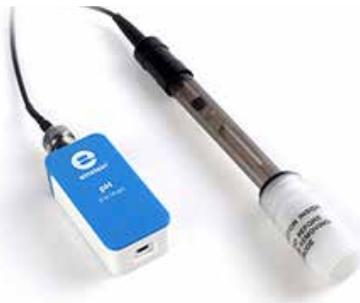
Ce capteur est capable de mesurer de pH 0 à pH 14 dans diverses expériences en biologie, chimie et sciences environnementales. Il peut remplacer un pH-mètre traditionnel. On recueille automatiquement les données de pH ainsi que les variations de pH au cours des réactions chimiques, puis les affiche sur le graphique. La sonde est compensée en température.
