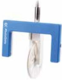
Ce dispositif est la combinaison d'une poulie et d'un dispositif optique. On l'utilise pour mesurer la vitesse d'une corde accrochée à la poulie mesurant ainsi la vitesse tangentielle de celle-ci.
