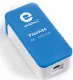
Il s'agit d'un capteur de pression absolue. Il mesure la pression externe appliquée par rapport à une référence zéro interne. La gamme mesurée va de 150 à 1150 mbar. Sa sortie est munie d'un connecteur Luer Lock permettant de brancher des seringues ou petits récipients.
