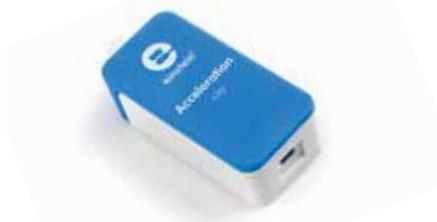
Le capteur d'accélération est un accéléromètre de grande précision capable de mesurer des accélérations allant de -5 à +5 g. Il mesure les forces de gravitation et les forces induites par l'accélération en même temps. Au repos le capteur indique 1g quand il est pointé vers le bas et -1g quand il est pointé vers le haut. Il indique 0 lorsqu'il est positionné horizontalement.
