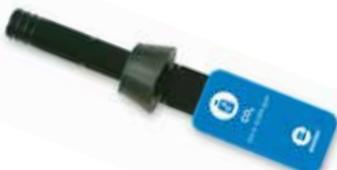
Ce capteur CO<sub>2</sub> mesure la concentration de dioxyde de carbone (ppm) dans des gaz tels que l'air. La cellule composée d'un électrolyte solide offre une grande sélectivité avec une faible dépendance à l'égard de l'humidité. Une gamme de 350 à 5000 ppm peut être détectée, idéal pour un contrôle de l'air intérieur. Fourni avec son enceinte en plastique de 100ml et un bouchon caoutchouc.
