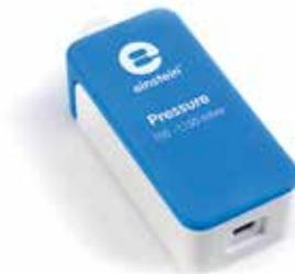
Il s'agit d'un capteur de pression absolue. Il mesure la pression externe appliquée par rapport à une référence zéro interne. La gamme mesurée va de 20 à 400 kPa (0,2 à 3,9 atm ou 200 à 4000 mbar). Sa sortie est munie d'un connecteur Luer Lock permettant de brancher des seringues ou petits récipients.
