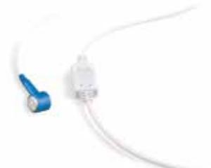
Ce capteur de température de surface de très grande précision mesure la température d'une très grande variété de surfaces, y compris la peau, par l'intermédiaire d'un élément plat. Flexible et parfaitement adapté
