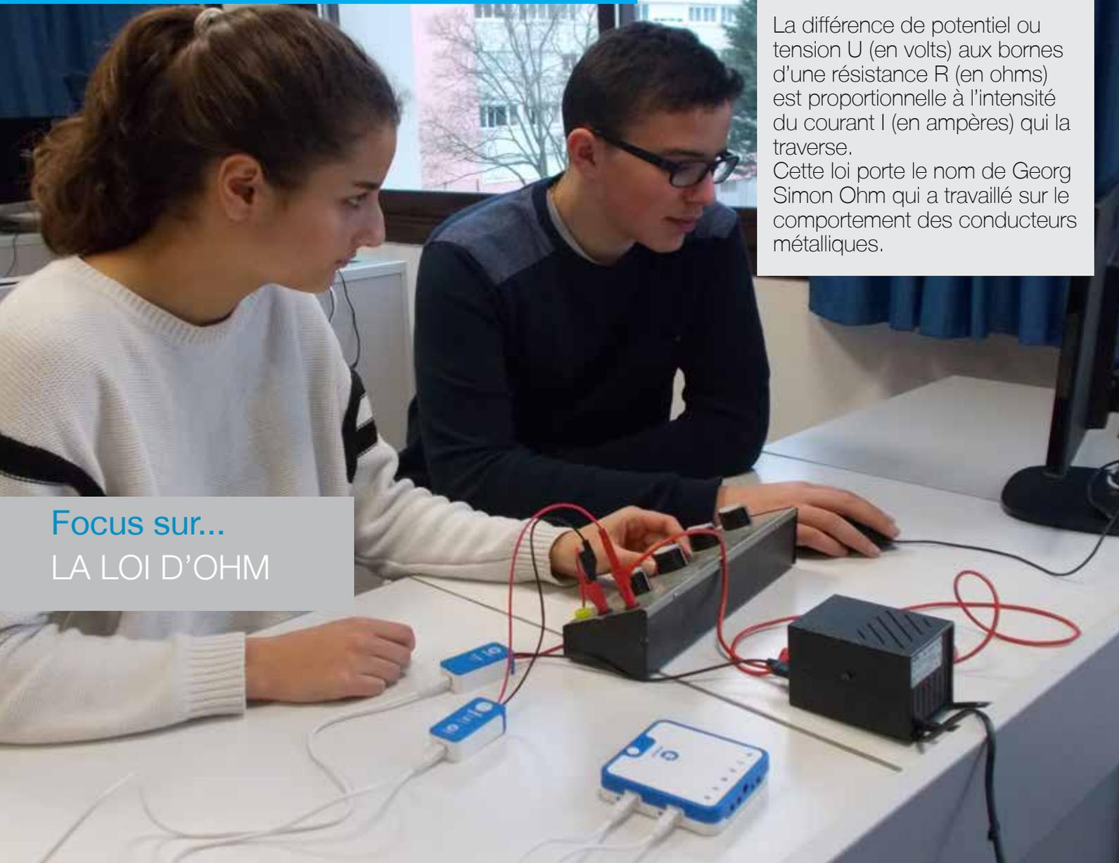
La différence de potentiel ou tension  $U$  (en volts) aux bornes d'une résistance  $R$  (en ohms) est proportionnelle à l'intensité du courant  $I$  (en ampères) qui la traverse.
