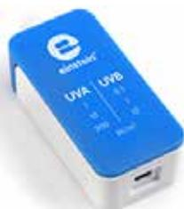
Le capteur UVA/UVB mesure l'intensité des rayons UVA incidents et UVB sur 3 gammes différentes. Il permet de réaliser un large éventail d'expériences et d'enquêtes de l'environnement.
