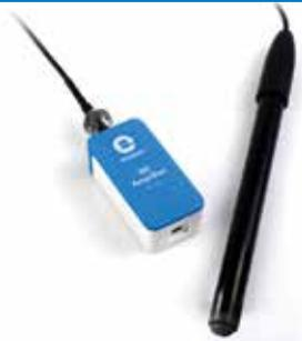
Ensemble composé d'une électrode sensible aux Ions Fluorure et d'un boîtier adaptateur. Electrode ionique pré-remplie à gel Permafil avec chambre de référence scellée (non remplissable). Aucune solution de remplissage n'est nécessaire.
