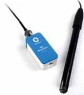
Ensemble composé d'une électrode sensible aux Ions Bromure et d'un boîtier adaptateur. Electrode ionique pré-remplie à gel Permafil avec chambre de référence scellée (non remplissable). Aucune solution de remplissage n'est nécessaire.
