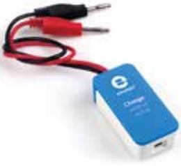
Il s'agit d'un capteur double gamme permettant la mesure de charges électrostatiques et pouvant être utilisé dans de nombreux cas. Il n'est pas sensible à l'humidité, il peut donc effectuer des mesures quantitatives et donner des indications de polarité de charge.
