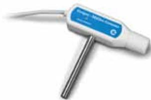
Ce capteur intègre un tube Geiger Muller sensible aux radiations alpha, beta, gamma.
