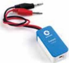
Le capteur différentiel est un ampèremètre capable de mesurer des valeurs allant de -250 mA à +250 mA. Mesurant à la fois des courants alternatifs et continus, il est doté de 2 fiches bananes 4mm à reprise arrière.
