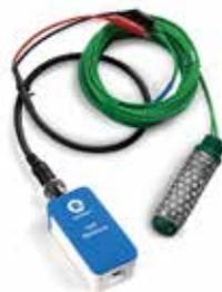
Ce dispositif haute performance et de haute précision permet la mesure de l'humidité du sol allant de 0 à 200 centibars (cb). En mesurant la résistance électrique du sol, ce capteur transforme les données en valeurs calibrées traduisant les capacités de succion du sol.
