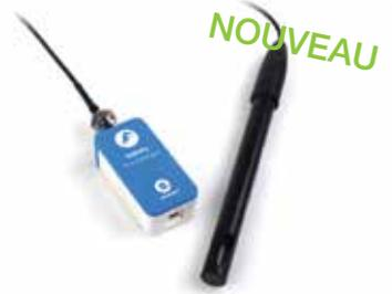
Le capteur de salinité est conçu pour mesurer la salinité des liquides et des solutions et est capable de mesurer la plage complète de 24 à 52 000 ppm (parties par million). La salinité est l'un des tests les plus élémentaires effectués dans les solutions. Il détermine la concentration totale de sel dans un échantillon
