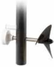
Ce dispositif mesure la vitesse de l'eau qui s'écoule dans une rivière, un ruisseau ou un canal. Il est équipé d'une poignée télescopique et d'une housse de protection.
