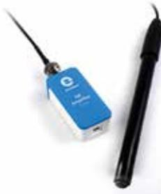
Ensemble composé d'une électrode sensible aux Ions Potassium et d'un boîtier adaptateur. Electrode ionique pré-remplie à gel Permafil avec chambre de référence scellée (non remplissable). Aucune solution de remplissage n'est nécessaire.
