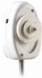
Ce dispositif haute résolution mesure un déplacement angulaire et peut aussi compter des tours de poulie. Il est adapté pour mesurer le mouvement linéaire avec une résolution de 0,1mm, en faisant tourner la poulie le long d'un plan ou en enroulant une corde directement sur la poulie. Il est livré avec une poulie triple gorge et une tige de montage. Un pendule est disponible en option se fixant directement sur la poulie. Deux masses en laiton viennent compléter cette option.
