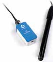
Ensemble composé d'une électrode sensible aux Ions Plomb et d'un boîtier adaptateur. Electrode ionique pré-remplie à gel Permafil avec chambre de référence scellée (non remplissable). Aucune solution de remplissage n'est nécessaire.
