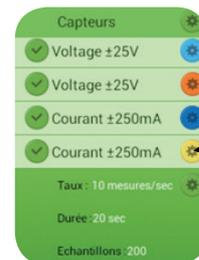
Bouton de réglage des paramètres du capteur
