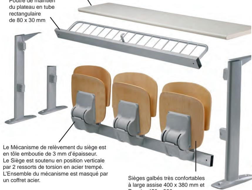
Le Mécanisme de relèvement du siège est en tôle emboutie de 3 mm d'épaisseur. Le Siège est soutenu en position verticale par 2 ressorts de torsion en acier trempé. L'Ensemble du mécanisme est masqué par un coffret acier.
