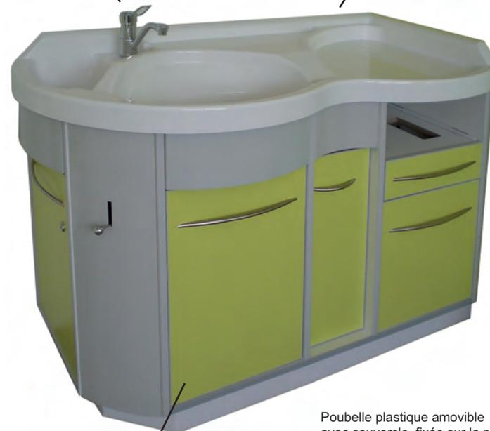
Meuble en panneaux surfacés mélaminé (PPSM) de 19 mm (coloris selon palette), Hydrofuge (CTBH), avec 1 tiroir sous le change et Placards à Portes sur charnières invisibles réglables. Chants PVC et Poignées Métalliques
