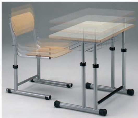
Structure en "C" constituée d'une double colonne de tubes de 28 mm, qui coulissent dans 2 tubes de 32 mm pour permettre le réglage en hauteur du plateau
